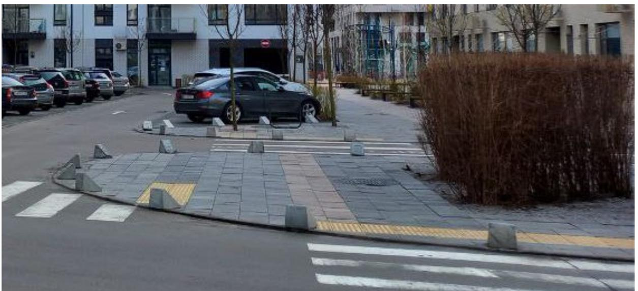
*Рис. Приклади спеціальних тактильних смуг*
