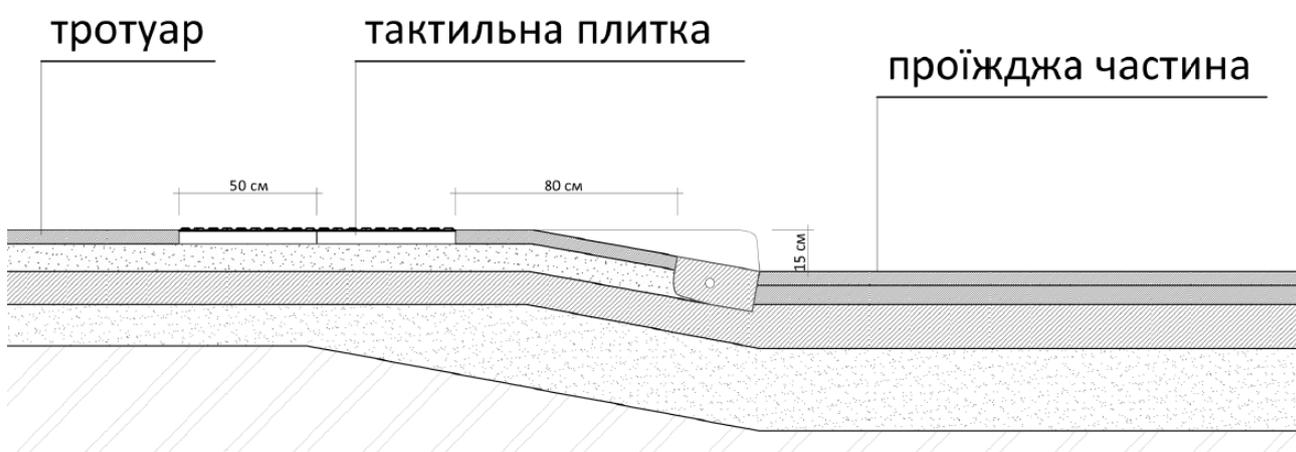
Рис. Схема встановлення пониженого бортового каменю в місці примикання тактильних поверхонь тротуару і проїжджої частини
