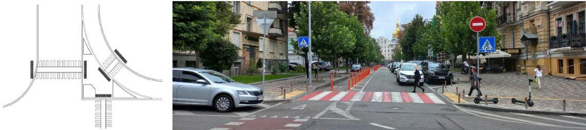
*Рис. Приклади застосування попереджувальної тактильної смуги перед наземним пішохідним переходом.*
