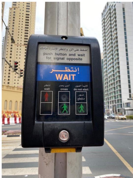
*Фото. Обладнання світлофору зі звуковим сигналом і кнопкою увімкнення*
