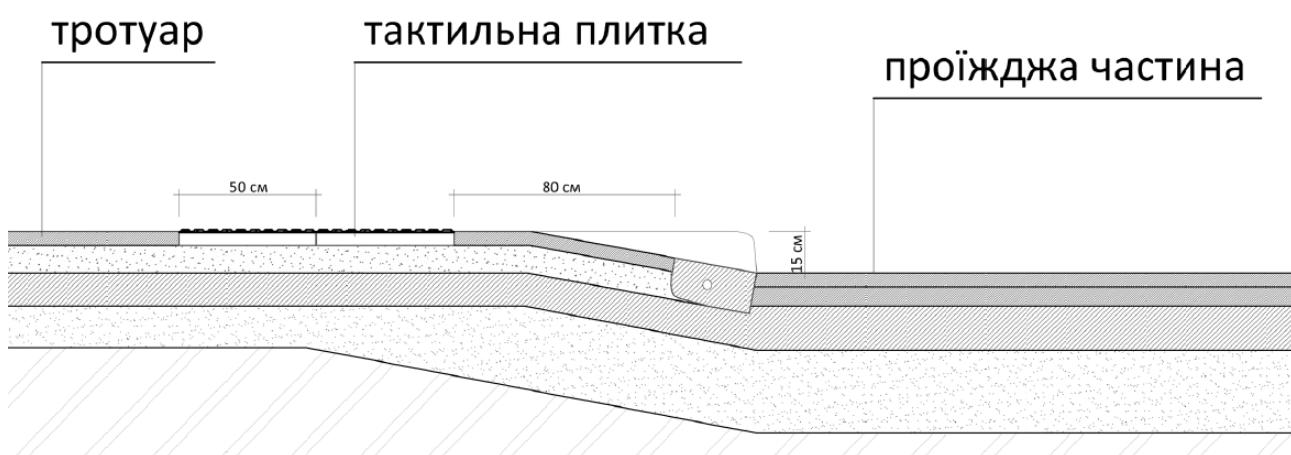
Рис. Схема встановлення пониженого бортового каменя в місці примикання тактильних поверхонь тротуару і проїжджої частини
