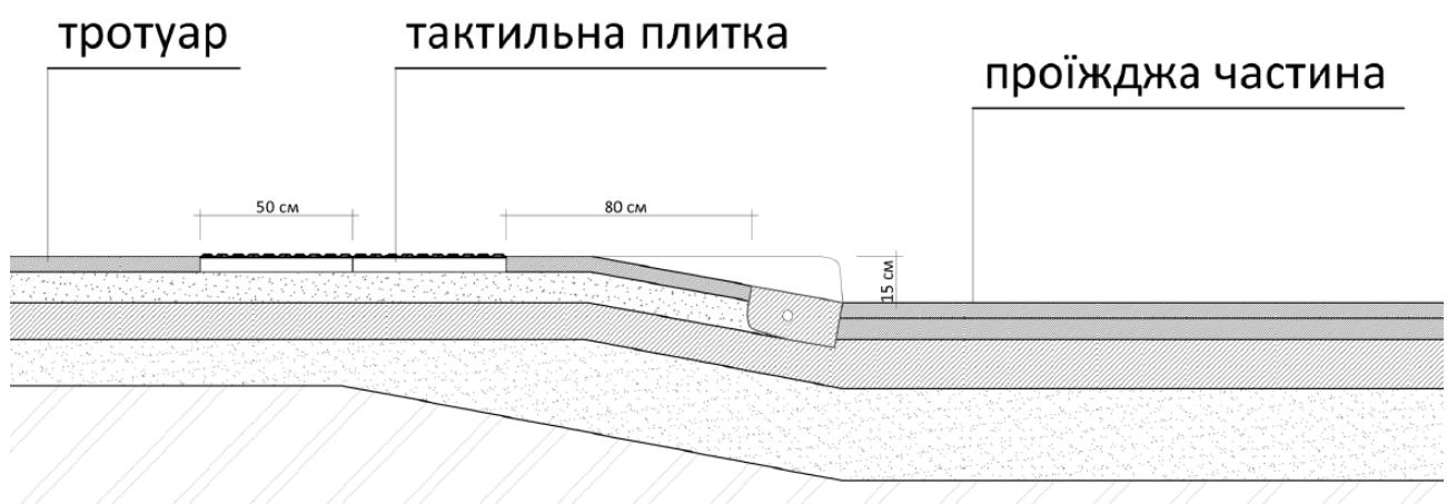
*Рис. Схема встановлення пониженої бортової каменю в місці примикання тактильних поверхонь тротуару і проїзджої частини*
