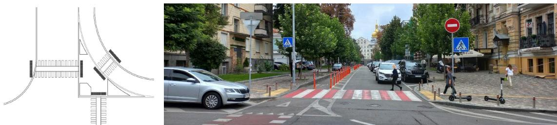
*Рис. Приклади застосування попереджуvalnoї тактильної смуги перед наземним пішохідним переходом.*
